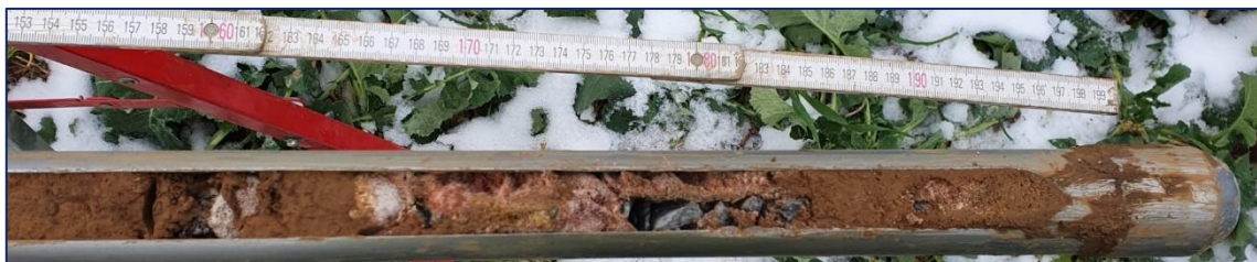
Bild 9: Flussschotter in der Bohrsonde RKS 2 [13]
