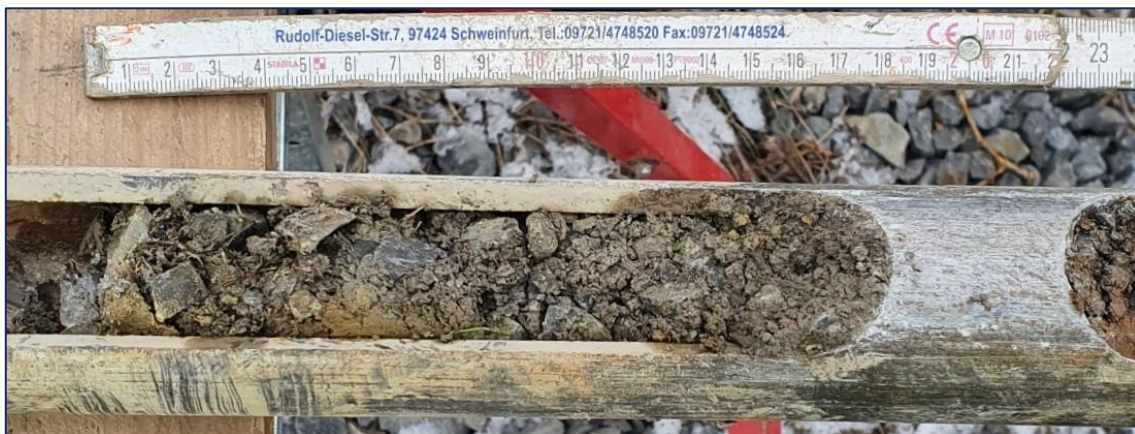
Bild 3: Schotter in der Bohrsonde der RKS 4 [13]
