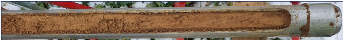
Bild 5: Löss-/Decklehm in der Bohrsonde der RKS 3 [13]
