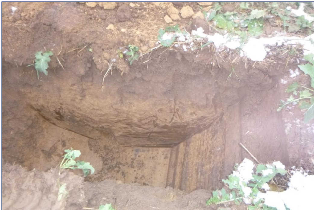
Bild 7: Löss-/Decklehm (unten; hellbraun, ocker) im Schurf 6 [13]
