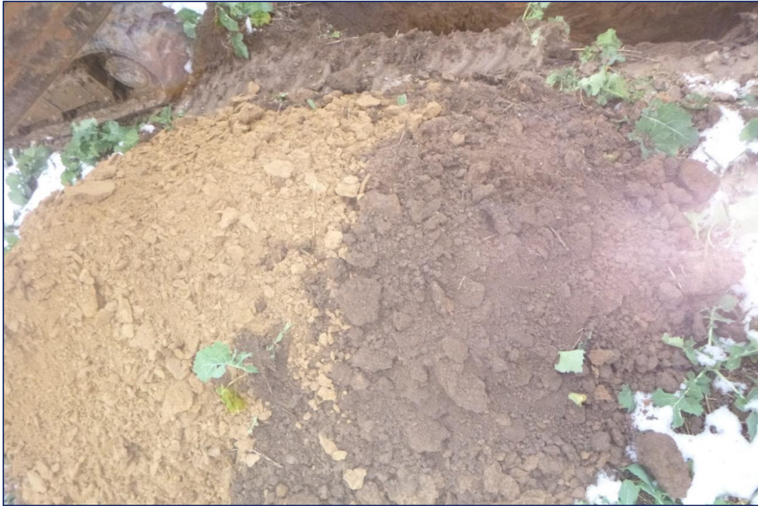
Bild 6: Löss-/Decklehm (links; hellbraun, ocker) im Schurf 6 [13]
