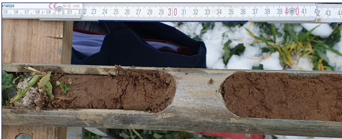
Bild 4: Mutterboden in der Bohrsonde der RKS 2 [13]
