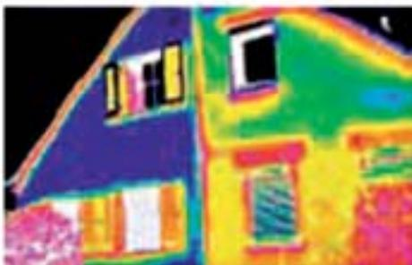
Vergleich einer gedämmten (linke Haushälfte) und einer ungedämmten Doppelhaushälfte. Das Wärmebild macht die Verluste durch Wärmebrücken deutlich.
